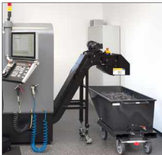
Anwendungsbeispiel: Muldenkipper als Spänebehälter
