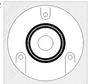
3. Bohrungsposition auf den Untergrund übertragen
