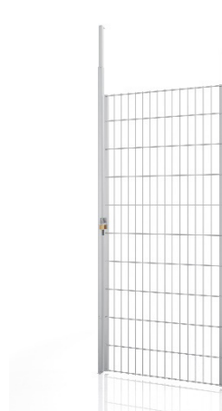
Drehtür für Trennwanggitter 1 x Türflügel BxH 1000 x 1.980 mm 2 x Türpfosten 30 x 30 x 1,5 x 2.400 mm 2 x Teleskope 25 x 25 x 1,5 x 750 mm Türanbauset Schellen zur Gitterbefestigung Boden- und Deckenbefestigung Bestell Nr. DTF198100-K
